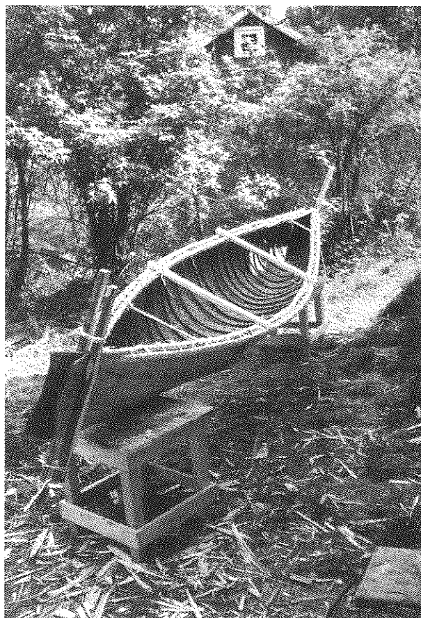
8. Surrade fast 2 tvärträn och breddade därvid kanoten till 70 centimeter på mitten. (Denna breddning borde jag nog ha gjort redan från början.) Den indianska modellen var något smalare.
